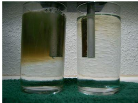
Abb: links Leitungswasser mit Rost, rechts Umkehrosmosewasser (es fehlen die wertvollen Mineralien)
